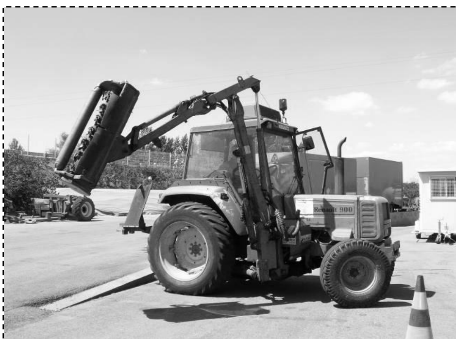
Figure 2 : Epareuse du centre d'exploitation des liaisons autoroutières (centre LACRA ; photo Laborde N.)
